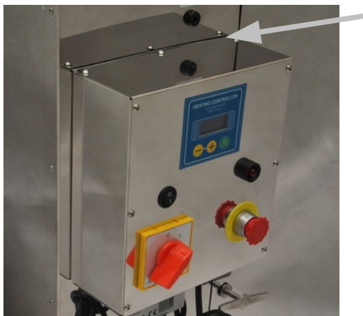
Рис. 2 Сброс происходит при помощи помещения отвертки в отверстие и легкого нажатия на нее
