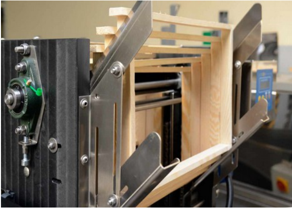
Рис. 11 Регулирование скользунов к высоте рамок
