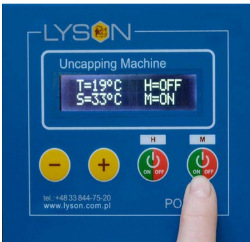
Рис. 9 Включение распечатывающих ножей кнопкой номер 4 „ON/OFF”. После включения ножей на контроллере отображается описание „ON”, ножи распечатки начинают перемещаться.
