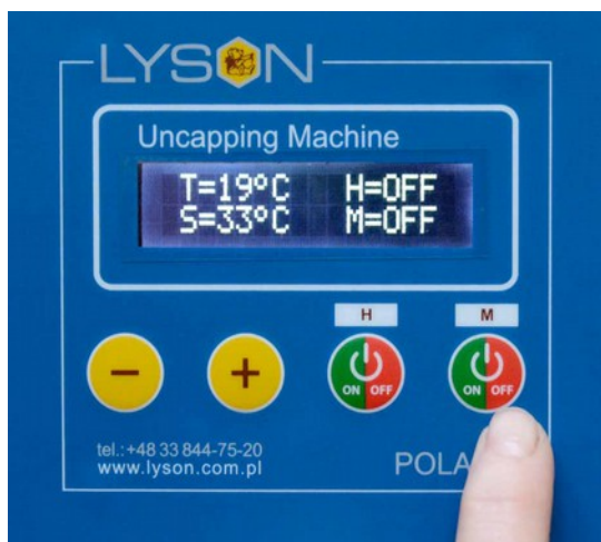
Рис. 10 Выключение распечатывающих ножей кнопкой номер 4 „ON/OFF”. После включения ножей на контроллере появится описание „OFF” - ножи останавливаются.
