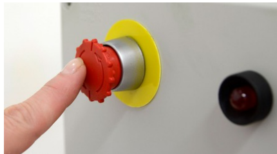
Рис. 20 Аварийная кнопка «СТОП»
