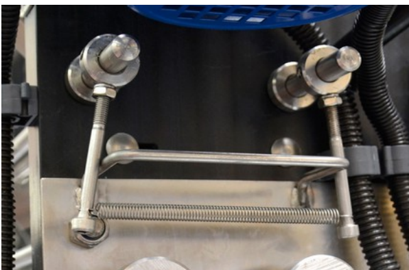
Рис. 13 Винты с помощью которых можем регулировать прихват рамок
