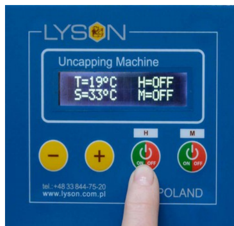
Рис. 8 После выключения грелок на контроллере отображается описание „OFF”, зато с левой стороны графическое сообщение не появляется.
