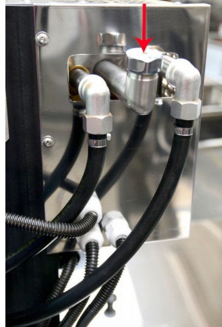
Рис. 19 кран, через который дополняем бак жидкостью
